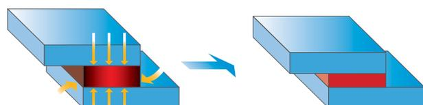
La colle est appliquée et l'assemblage maintenu jusqu'à ce que la réaction avec l'humidité ait permis de développer la résistance nécessaire à la manipulation.
