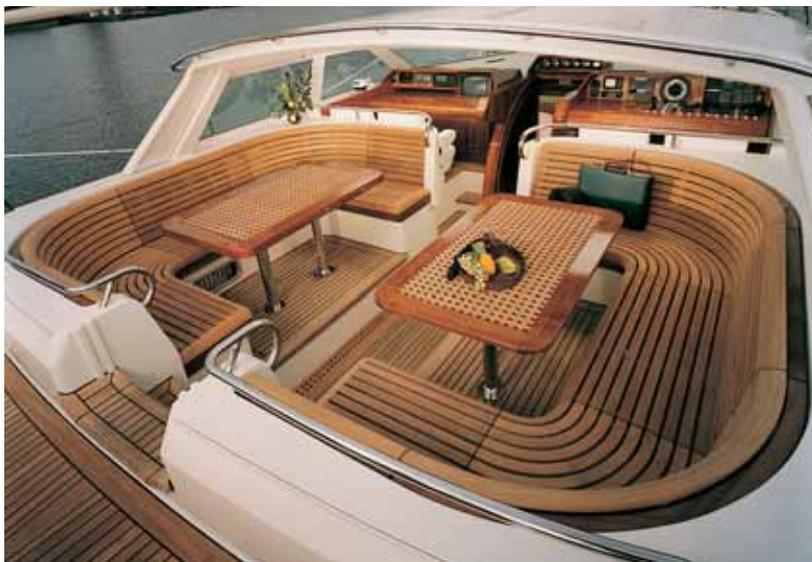
Le collage souple permet d'assembler et d'étancher dans le respect des contraintes évoquées ci-dessus ; mais également d'assurer l'isolation acoustique et thermique.
