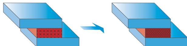
Les deux éléments réactifs de la colle sont mélangés, le joint est appliqué et l'assemblage maintenu jusqu'à obtention de la résistance nécessaire à la manipulation.
