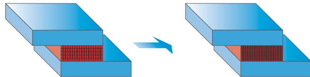
L'assemblage est maintenu le temps nécessaire à la solidification de la colle par refroidissement.
