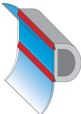
Les listons en bois, en PVC ou en polyuréthane peuvent être collés sur la coque avec le Sikaflex®-292 (autres matières, nous consulter). Le joint souple ainsi formé contribue à absorber l'essentiel des contraintes de cisaillement et de traction auxquelles sont soumis les listons au moment d'accoster ou d'appareiller.
