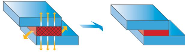
Evaporation de l'humidité ou des solvants contenus dans la colle (surfaces ouvertes et / ou substrats poreux).
