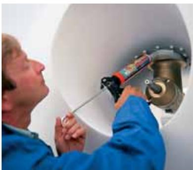
Étanchéité du propulseur d'étrave
